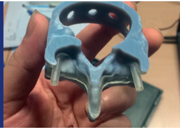
DIMA VERTEBRALE OTTENUTA TRAMITE STAMPA 3D.
