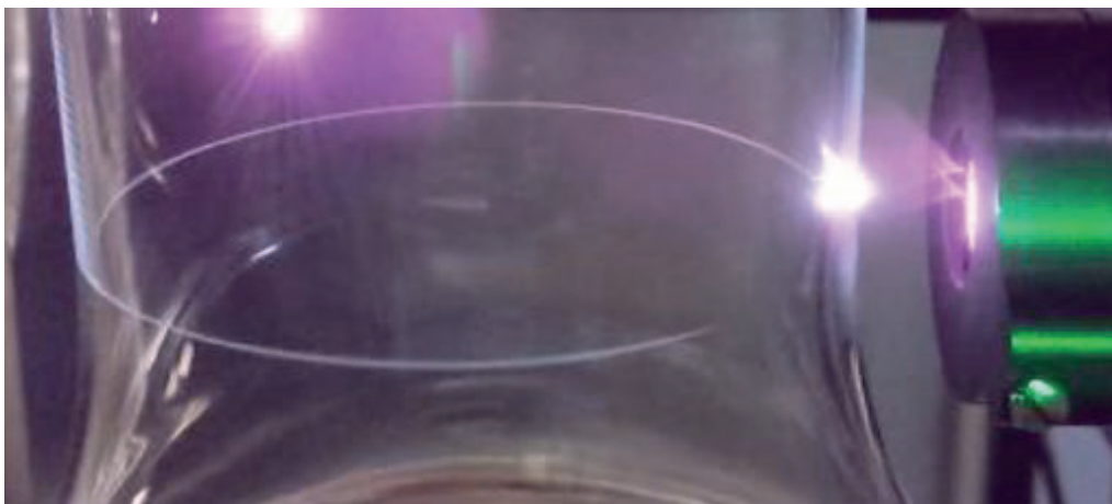
Taglio di filamentazione su un bicchiere di vino eseguito con il laser HyperRapid NX di Coherent.
