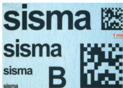
5. Esempio di marcatura di caratteri e UDI su placchetta di acciaio AISI 304, post-trattamenti.
