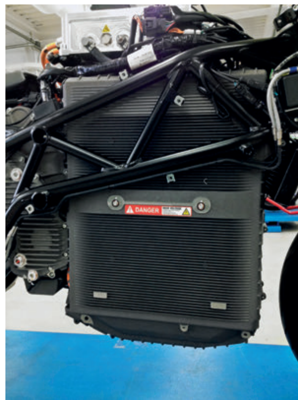
3. DETTAGLIO DELLA CASSA BATTERIA IN ALLESTIMENTO.
