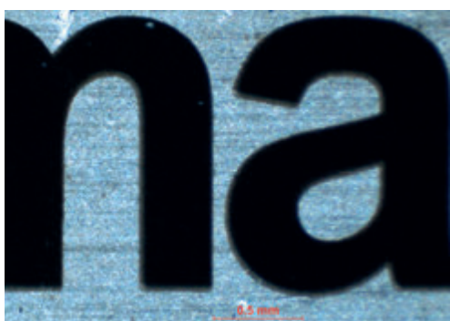
6. Esempio di marcatura su placchetta di acciaio AISI 304 (dettaglio ingrandito).
