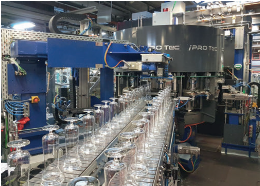
Il sistema proposto da IPROTEC è una macchina completamente automatica in grado di eseguire la rimozione del tappo di un bicchiere da vino utilizzando la tecnologia di taglio SmartCleave, che raggiunge una velocità massima di 80 pezzi/min.
