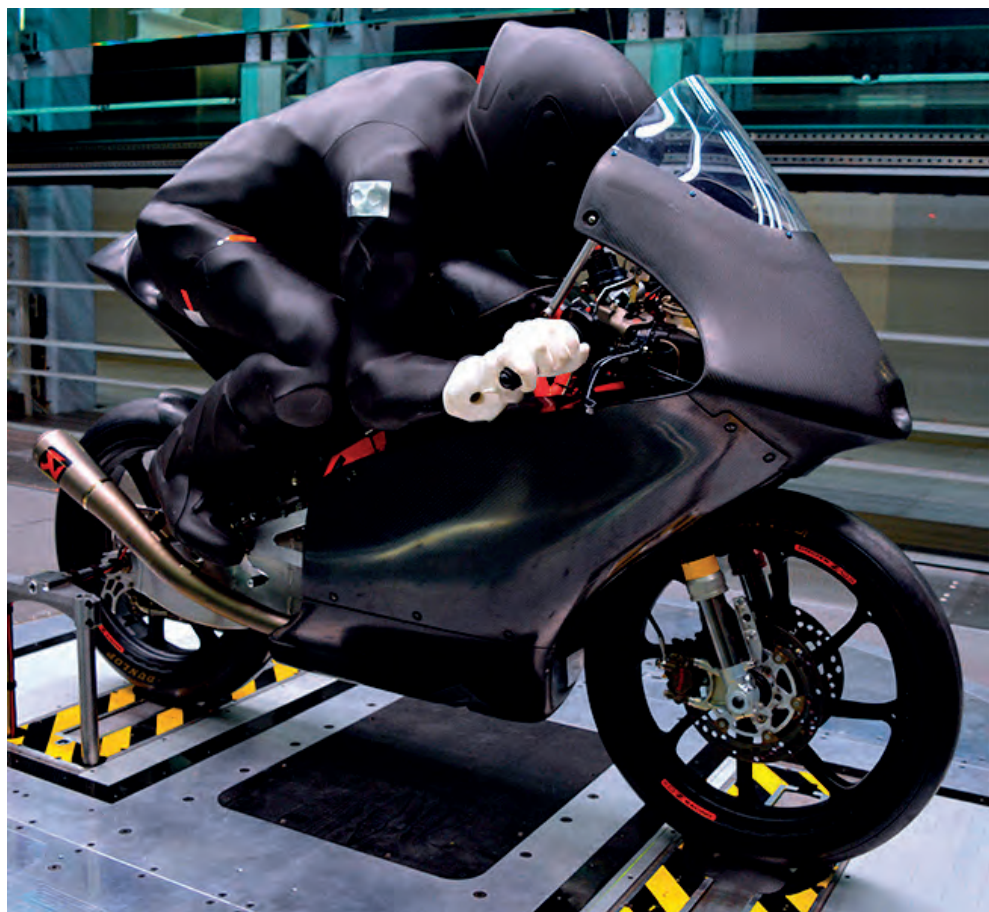
KTM Factory Racing sfrutta le potenzialità della tecnologia additiva SLS per creare i dummies, una serie di manichini in poliammide PA12 che mette sulle moto, durante i test, sotto getti d'aria che superano i 200 km/h, salvaguardando l'incolumità fisica dei suoi piloti.
