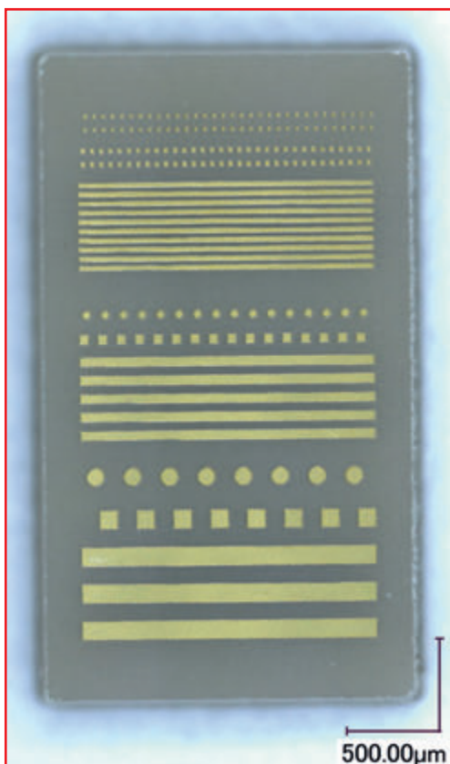
Un esempio di componente in substrato GaN con strato superiore dorato microinciso
