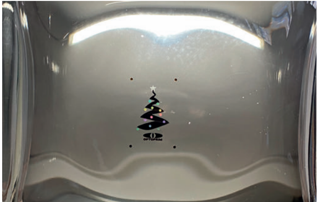
Un esempio di marcatura nera e olografica intravolume nel vetro.
