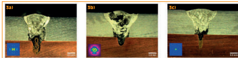
Beam shaping per la saldatura laser e relative applicazioni dalla collaborazione PULSATE-Weldshape tra CIVAN e BBW Lasertechnik. Nelle figure 3a, 3b e 3c degli esempi di sezioni trasversali di alluminio-rame saldate (© CIVAN).
