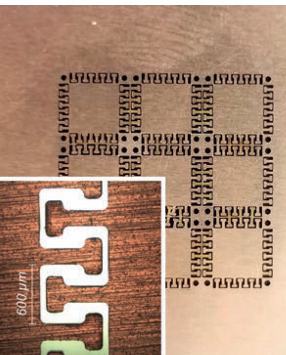
Esempio di applicazione di taglio rame per micro-elettronica.
