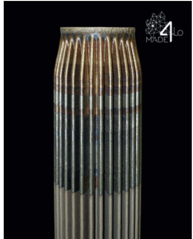
PARTICOLARE DELLA SUPERFICIE DEL RECUPERATORE, CON DISTINZIONE TRA I DUE MATERIALI.
