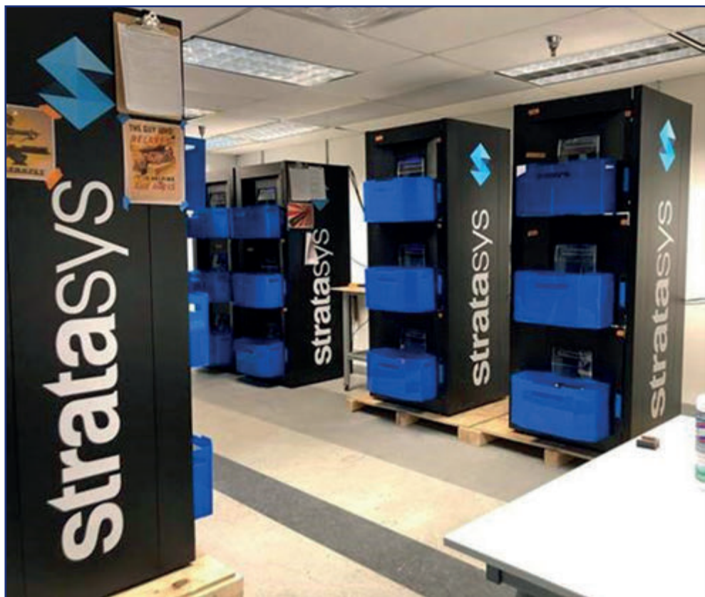
TORRI DI STAMPANTI 3D CONTINUOUS BUILD PRESSO LA SEDE DI STRATASYS LABS.
