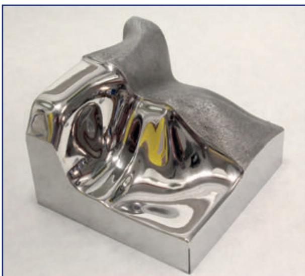
L'ACCIAIO UTILIZZATO PER L'INSERTO PRODOTTO CON LA PRODUZIONE ADDITIVA È STATO UDDEHOLM AM CORRAX®, UN MATERIALE SVILUPPATO PER GLI INSERTI PER LO STAMPAGGIO DELLA PLASTICA E LE ESIGENZE SPECIFICHE PER IL PROCESSO DI STAMPAGGIO.
