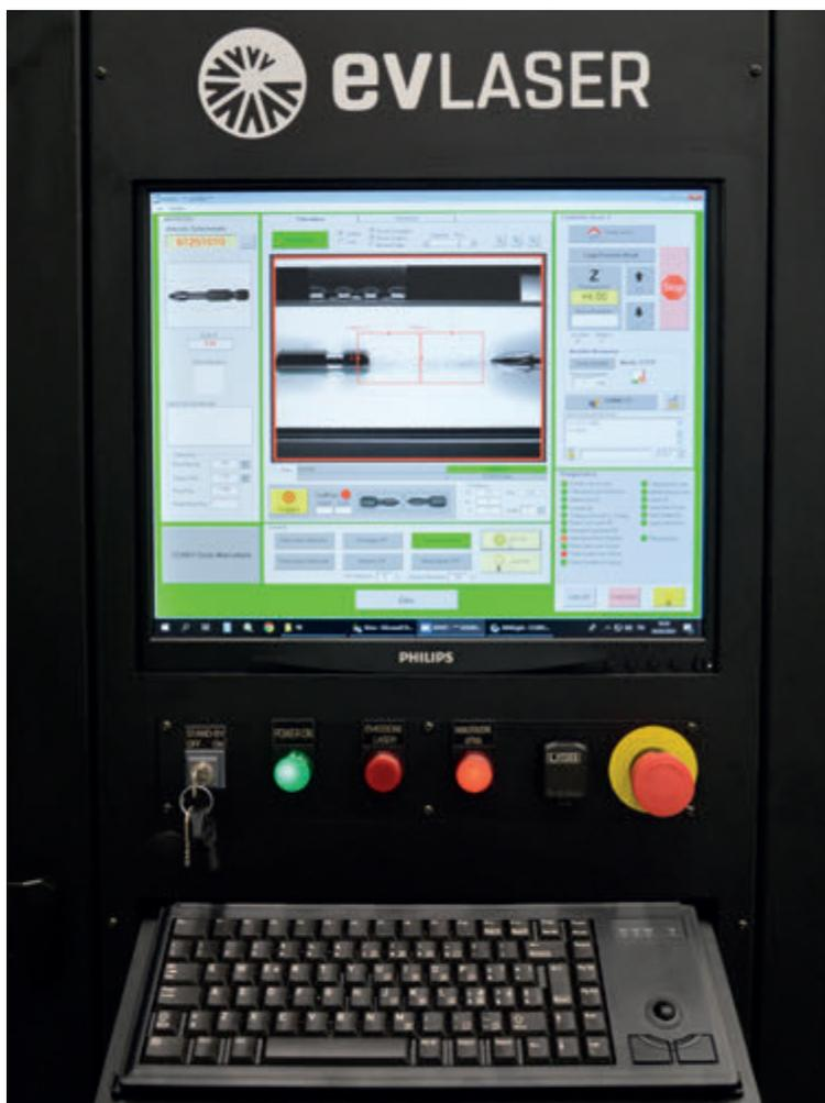
Il software di gestione macchina permette il controllo di tutti i parametri coinvolti nel processo, da quelli laser alla gestione del binomio tramoggia/vibratore fino al sistema di visione.
