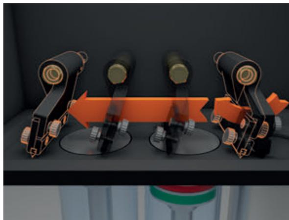
**IL SISTEMA DI TILTING COATER BREVETTATO DA SISMA RUOTA VERSO L'ALTO PRIMA DI TORNARE ALLA POSIZIONE DI RACCOLTA DELLA POLVERE, EVITANDO IN QUESTO MODO OGNI CONTATTO CON IL PIANO DI COSTRUZIONE E IL MATERIALE PRESENTE NEL CILINDRO DI CARICO.**
