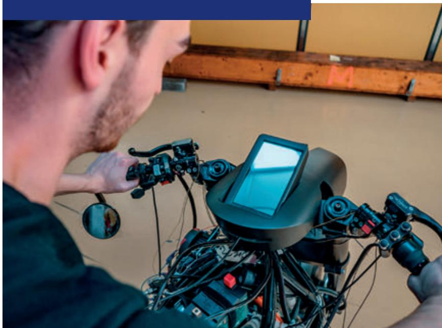
L'ALLOGGIAMENTO DEL DISPLAY FRONTALE È STATO REALIZZATO RAPIDAMENTE, RECAPITATO E, DOPO VERNICIATURA, MONTATO SULLA MOTO PER USO FINALE.
