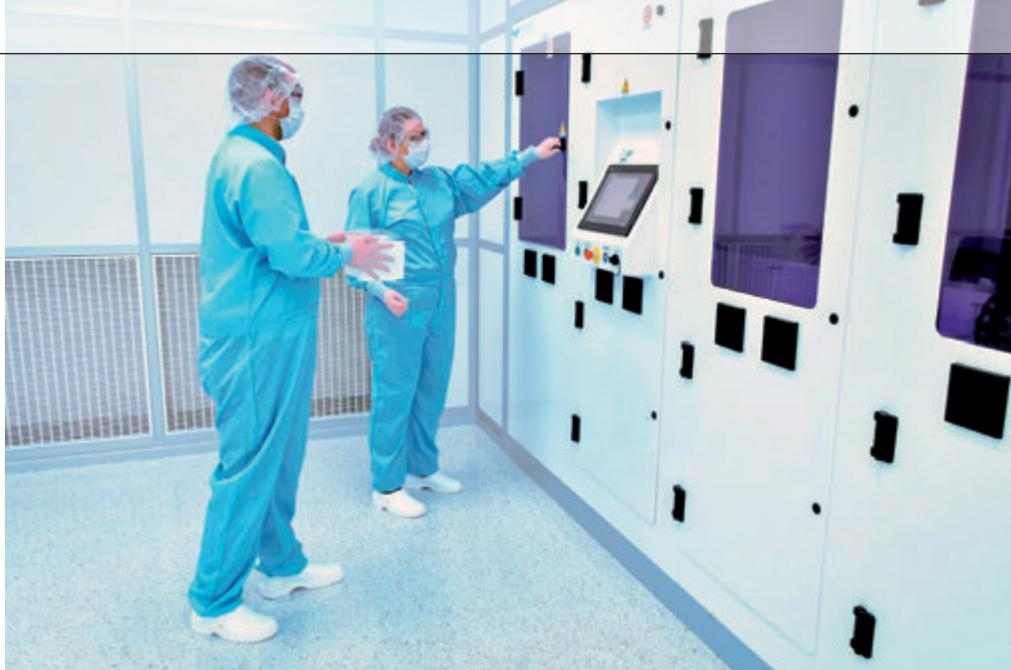
Con un ricambio completo dell'aria ogni 60 secondi e condizioni climatiche controllabili con precisione, la fabbrica soddisfa tutti i requisiti di una camera bianca di produzione.
