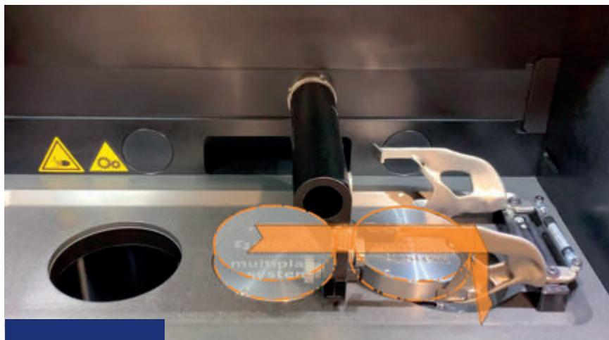
**MULTIPLATE È UN DISPOSITIVO OPZIONALE, INTEGRATO NELLA CAMERA DI LAVORO, CHE CONSENTE A MYSINT100 DI EFFETTUARE IL PROCESSO DI STAMPA 3D SU PIÙ PIATTAFORME IN SUCCESSIONE IN MODO COMPLETAMENTE AUTONOMO E SENZA INTERRUZIONI.**
