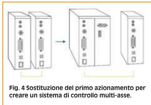
**Fig. 4** Sostituzione del primo azionamento per creare un sistema di controllo multi-asse.
