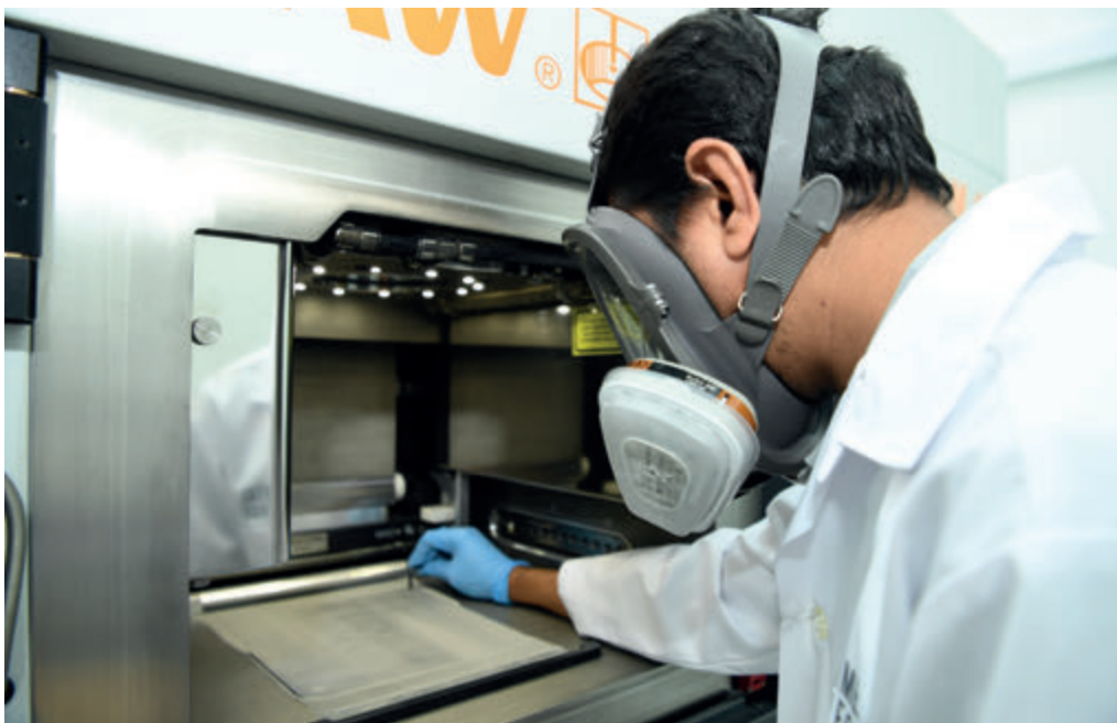
Camera di lavorazione di un sistema AM Renishaw.
