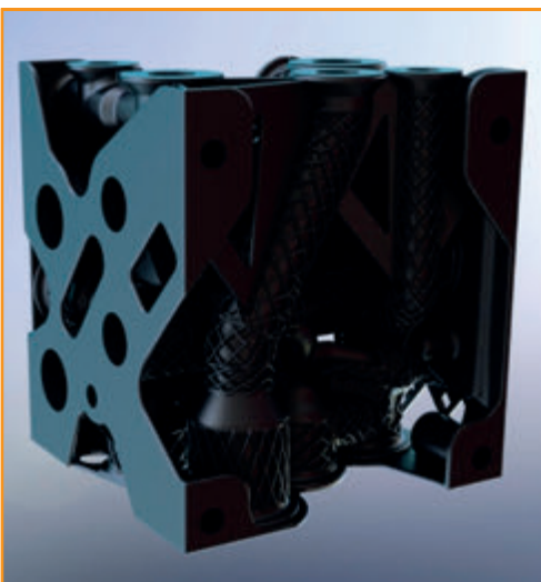
3. Esempio di un raccordo industriale in acciaio inossidabile AISI 316L, realizzabile in un unico pezzo solo tramite AM con conseguente riduzione di peso e ottimizzazione delle perdite di carico.
