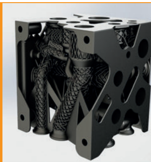
3. Esempio di un raccordo industriale in acciaio inossidabile AISI 316L, realizzabile in un unico pezzo solo tramite AM con conseguente riduzione di peso e ottimizzazione delle perdite di carico.
