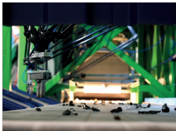
The Multipick automatized scrap metal sorting system Sistema automatizzato Multipick per la cernita dei rottami
