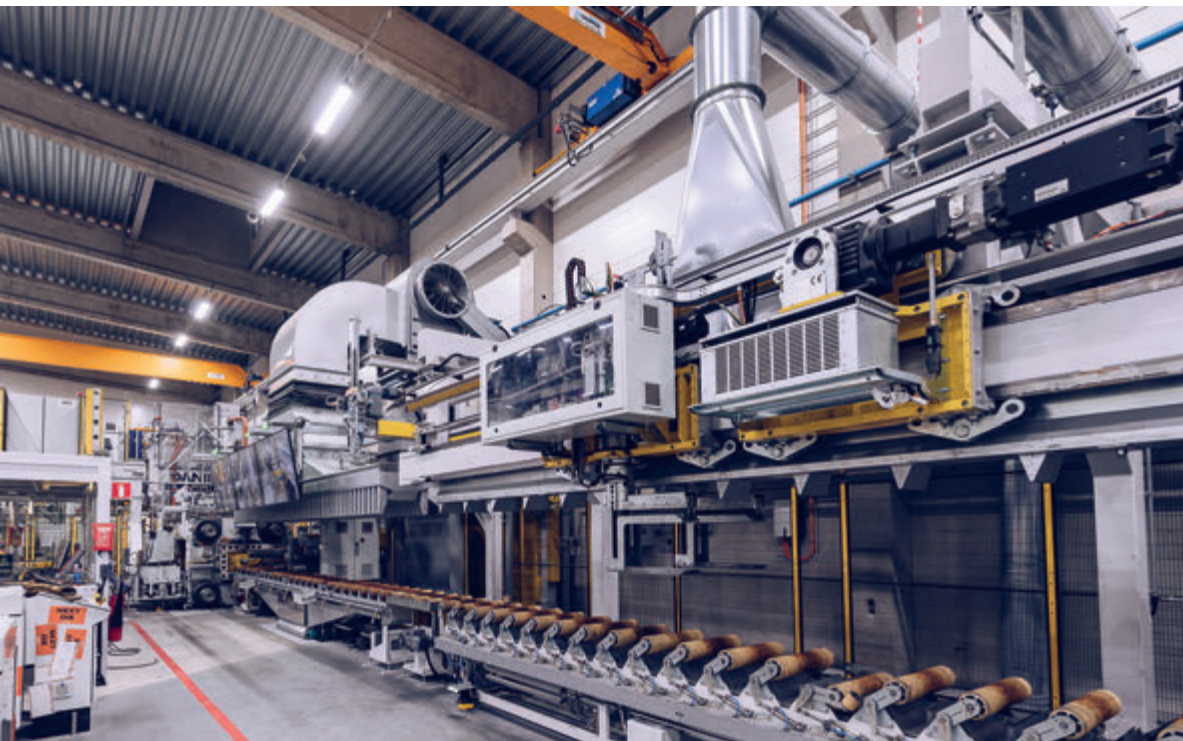
Intensive cooling box, double electrical puller and flying saw Linea di raffreddamento intensivo con doppio puller elettrico e sega volante
