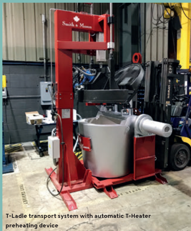
T-Ladle, sistema di trasporto sicuro e di pesatura dell'alluminio liquido
