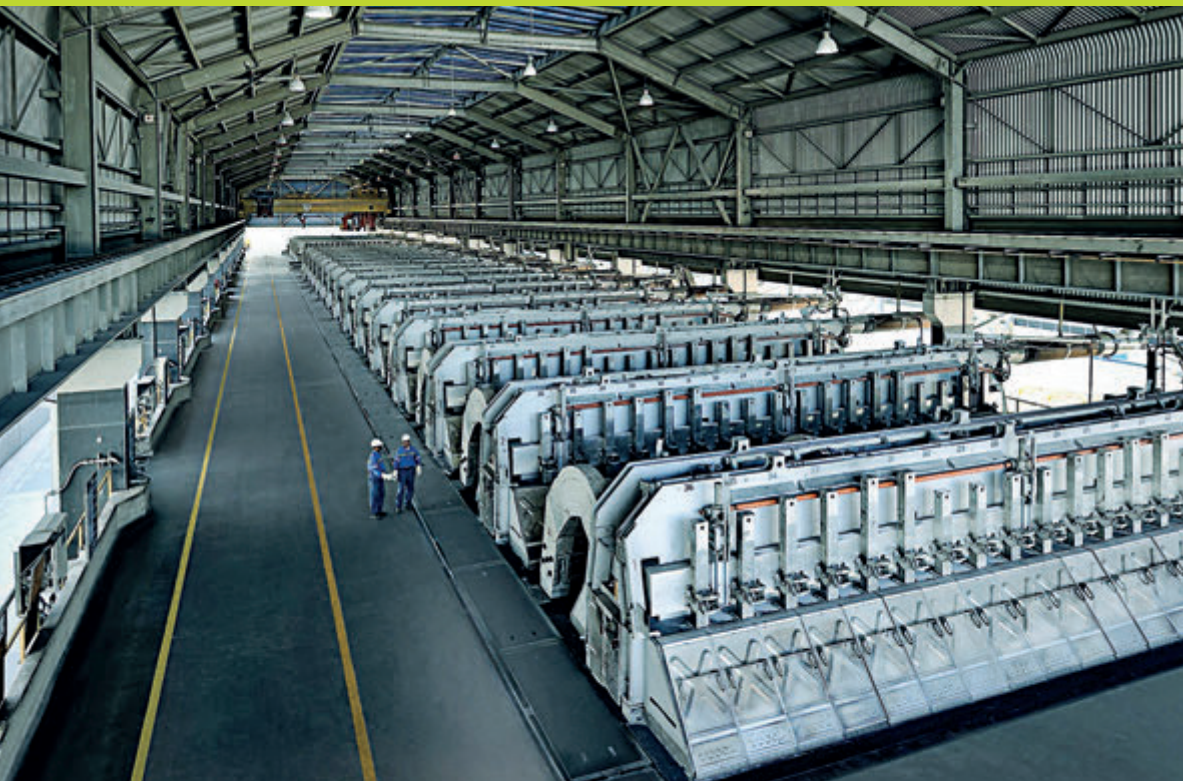
La nuova linea di riduzione elettrolitica dello smelter di Jebel Ali con celle di riduzione DX Technology, sviluppata da EGA (foto: Copyright © Emirates Global Aluminium)
